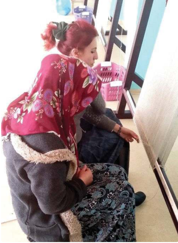
Fotoğraf 3: Dokumada kullanılacak iplerin tezgâhlara yerleştirilmesi.
