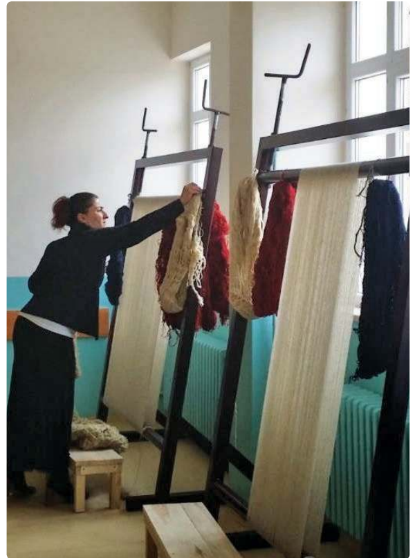
Fotoğraf 2: Dokumada kullanılacak iplerin tezgâhlara yerleştirilmesi.
