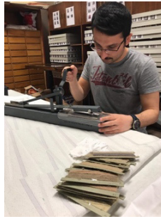
Fotoğraf 14: Sürtünme haslık ölçümü
