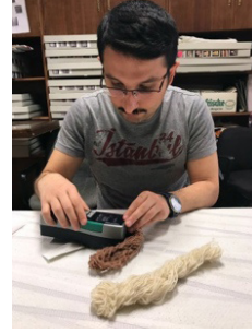
Fotoğraf 11: İpliklerin cihaz ile renk ölçümleri
