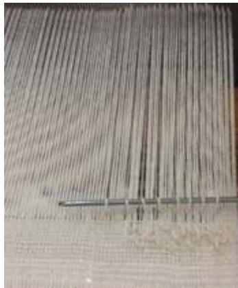
Fotoğraf 4: Tığ yardımı ile yüzeye çekilen atkı iplikleri 33
