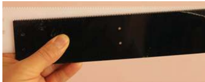
Fotoğraf 19: Çözgü sıklığını belirleyen düzenleyici taraklar
