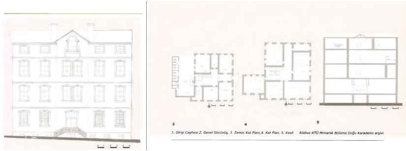
Çizim 19. Mevcut binanın cephe çizimi ve kat planları (Kaynak: Özen 2010: 263).
